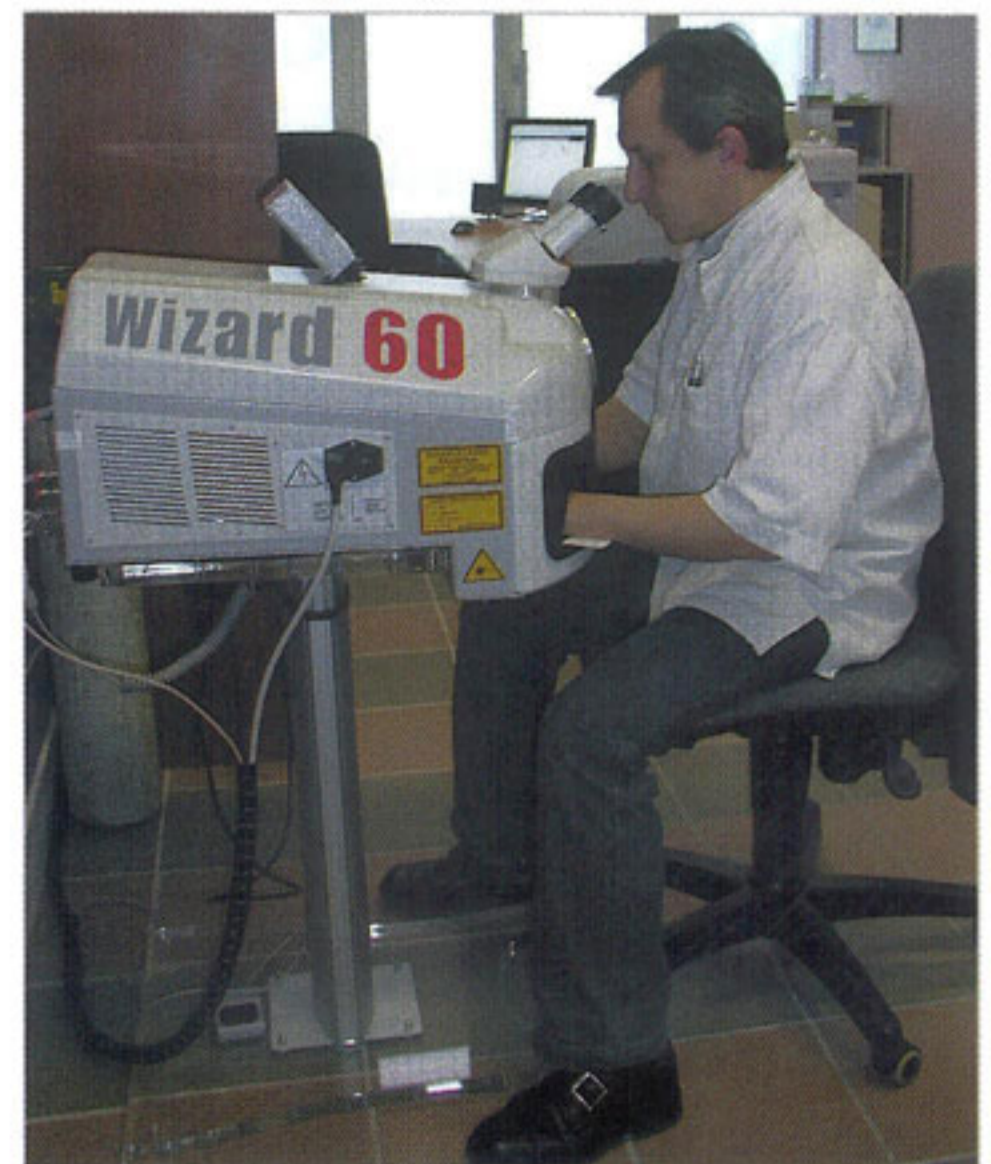
La soudeuse laser est indispensable à l'activité pour assurer la haute qualité du travail. La soudure laser s'opère par fusion des matériaux, sans apport de matière : elle est donc bio-compatible avec les exigences des alliages chirurgicaux de dernière génération (exempts de nickel, de cadmium...).
